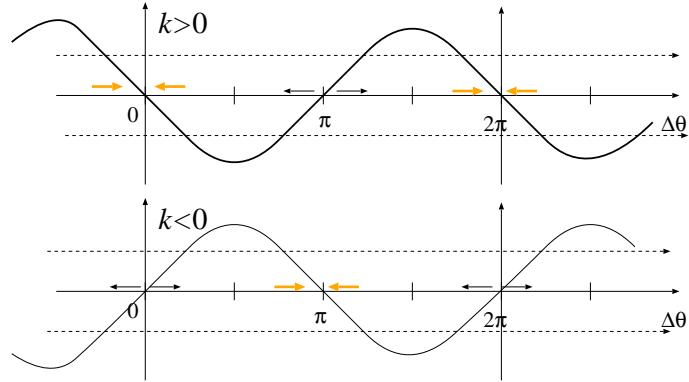
図 4: 位相差の時間発展 . 縦軸は  $\Delta\theta = \omega_1 - \omega_2$  (点線) ,  $-2k \sin \theta$  をプロット .  $\Delta\theta > -2k \sin \theta$  の領域では ,  $\Delta\theta$  が大きくなる方向に動く .
